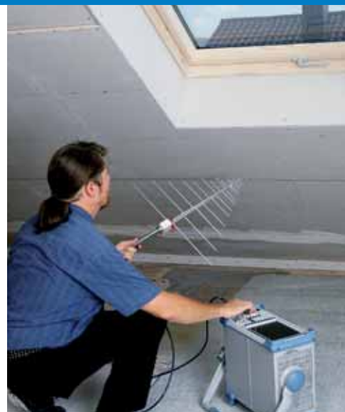
Merjenje s spektralnim analizatorjem
