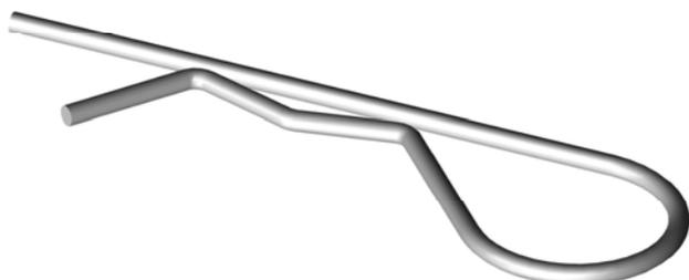
Rigips Nonius Sicherungsklammern aus Edelstahl dienen zur Verbindung von korrosionsgeschützten Nonius Ober- und Unterteilen bei der Ausbildung von Abhängungen in Gipsplattensystemen im Deckenbereich von Feucht- und Nassräumen. Die Verwendung erfolgt jeweils paarweise, da je Verbindung zwei Sicherungsklammern erforderlich sind.
