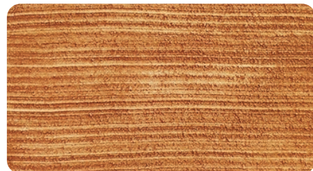
tehnika obdelave z omelom in nanos lazurne barve
