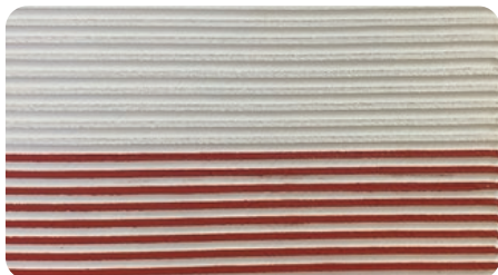
tehnika obdelave z glavnikom in barva
